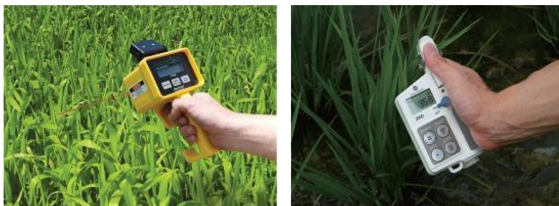
Figura 55. Diferentes tipos de medidores comerciales de clorofila. Izquierda: FieldScout CM 1000 Chlorophyll Meter (Spectrum Technologies, Inc., Aurora, IL, Estados Unidos). Derecha: Chlorophyll Meter. SPAD 502Plus (Konica Minolta Sensing Europe B.V.).
