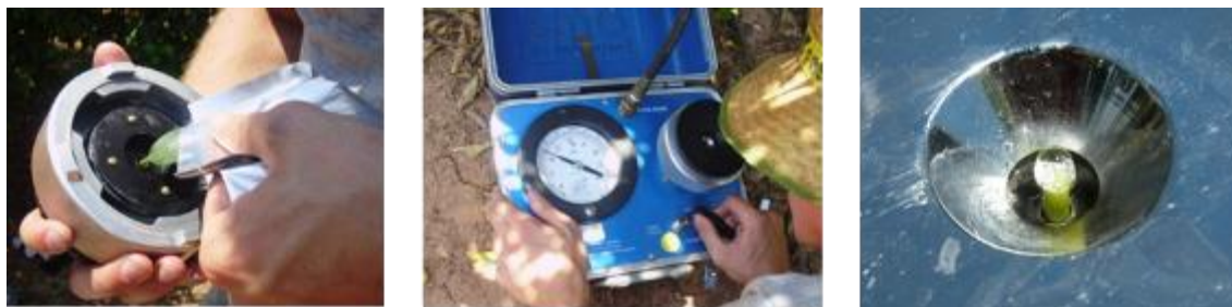
Figura 42. A) Inserción de la hoja en la cámara. B) Medida de potencial. C) Humectación del corte.
