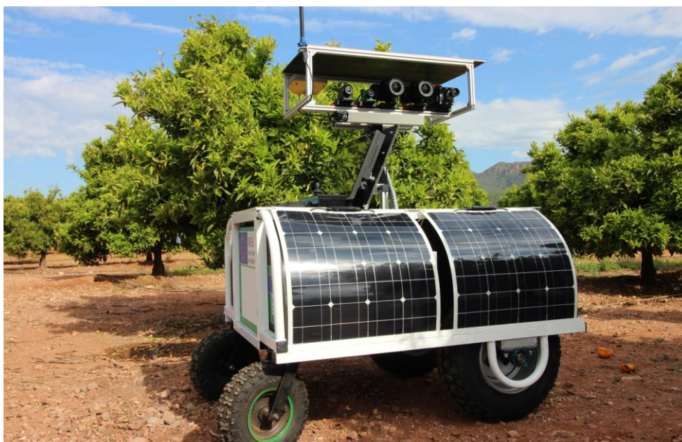
Figura 57. Robot agrícola sensorizado del IVIA, utilizado en los ensayos del proyecto GoCitrics.
