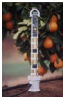
Figura 17. Ejemplos de sondas multisensores de medida de la humedad volumétrica del suelo.
