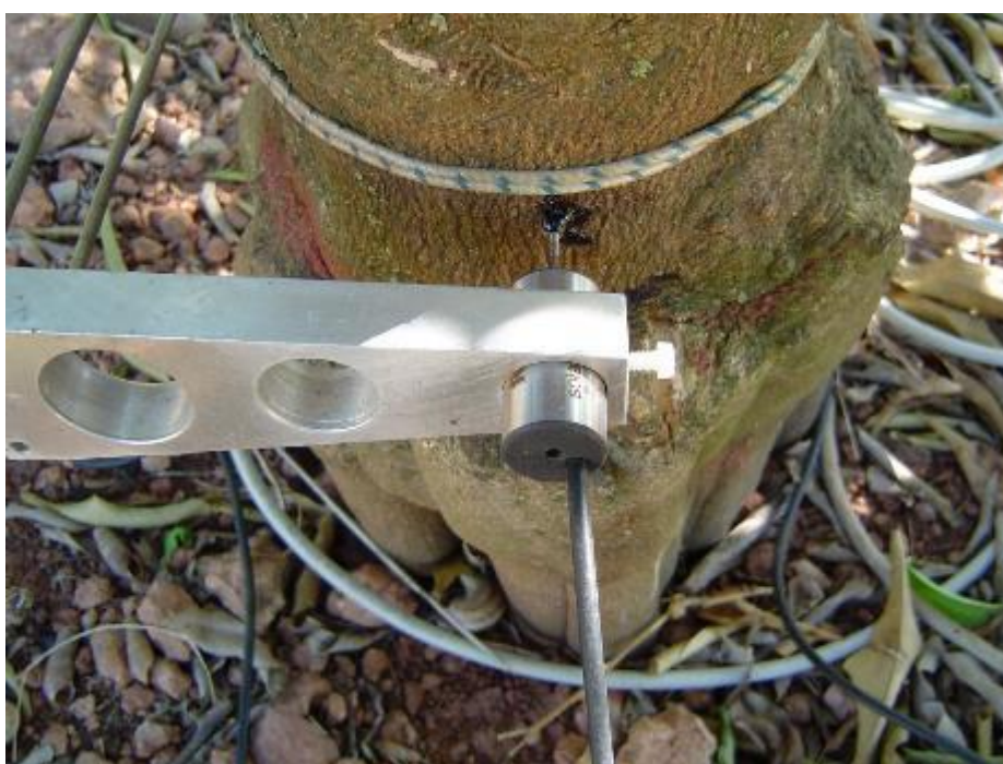
Figura 3. Detalle de un dendrómetro instalado en el tronco de un naranjo.
