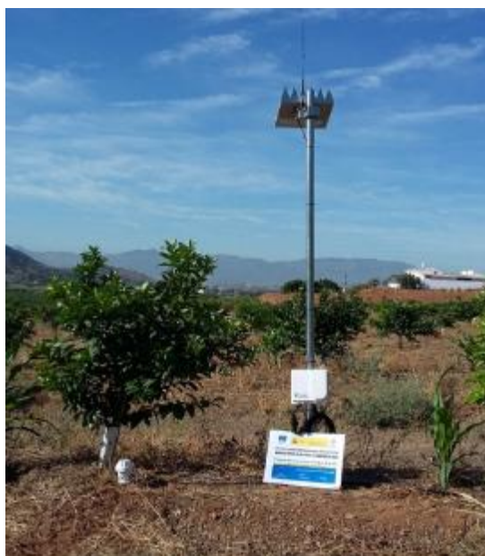
Figura 15. Sonda de humedad de suelo dotada sistema de adquisición y comunicación.
